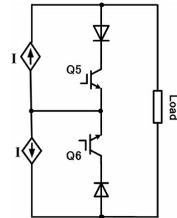
Fig. 2. Two-level CSI module
