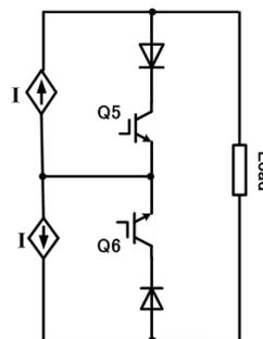
Fig. 2. Two-level CSI module
